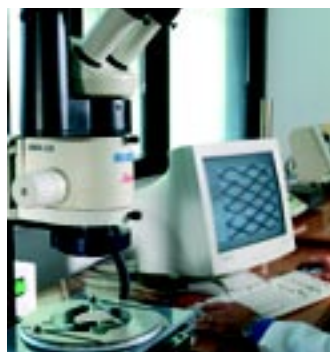
Controllo dimensionale con indagine microscopica ed elettronica della maglia in rete stirata
