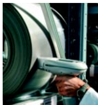
Strumento per il riconoscimento elettronico della composizione chimica della materia prima
